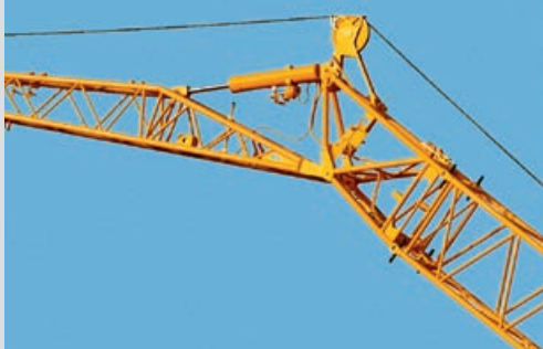
Гидравлически переставляемый откидной удлинитель (0° - 40°)
