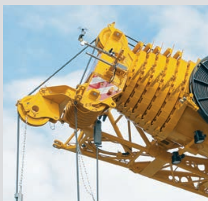
Дополнительная блочная головка, откидываемая в сторону
