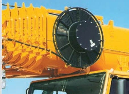
Барaban для намотки шланга для гидравлического цилиндра
